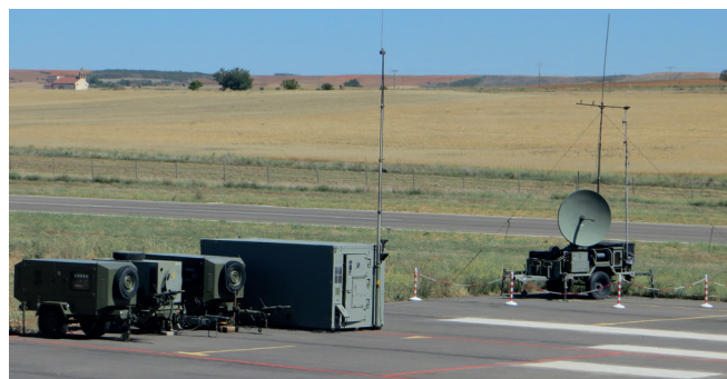
Imagen 31. Componente terrestre del sistema PASI, en primer plano, subsistema de energía, en medio la estación GCS y al fondo el subsistema GDT de comunicaciones en tierra. Fuente: fotografía del autor. Despliegue PASI en Base Aérea de Virgen del Camino (León) 2019.
