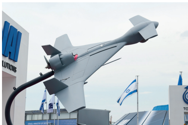
Imagen 65. Munición merodeadora IAI HAPSY. UAS de ataque de un sólo uso OWA (One Way Attack), usada en Nagorno Karabaj. Fuente: Wikipedia. Autor Julian Herzog. Creative Commons 4.0
