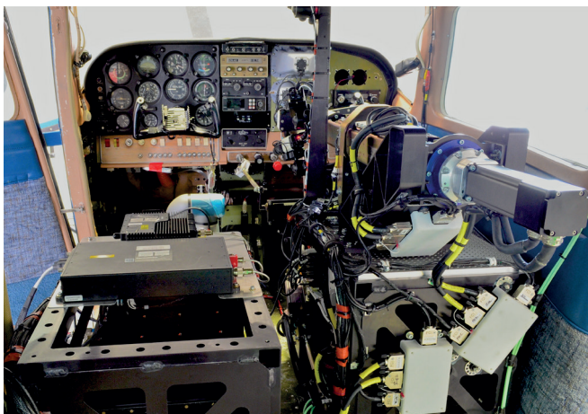
Imagen 40. Sistema robótico de pilotaje RoboPilot desarrollado por el laboratorio AFRL de la USAF en 2019. Fuente: USAF/AFRL
