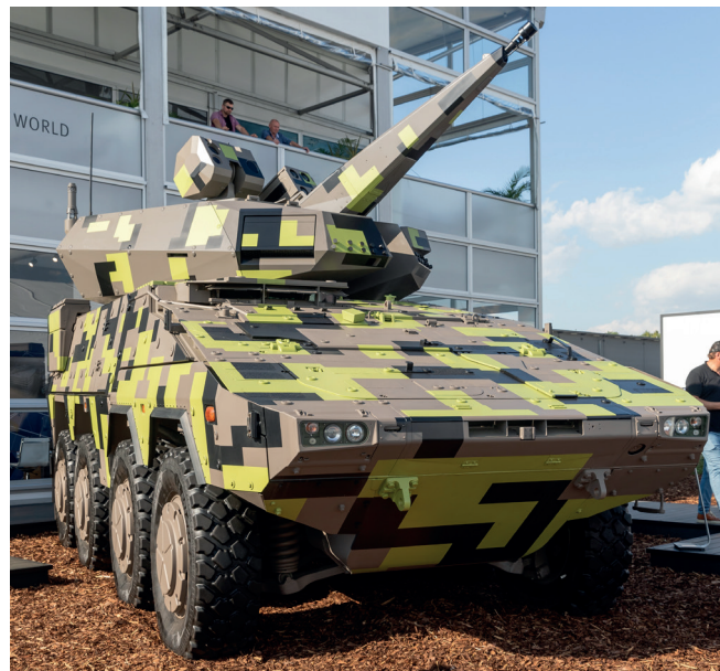
Imagen 49. Torre de defensa aérea Rheinmetall Skyranger 30 sobre vehículo Boxer. Fuente: Wikipedia. Crédito: Matti Blume
