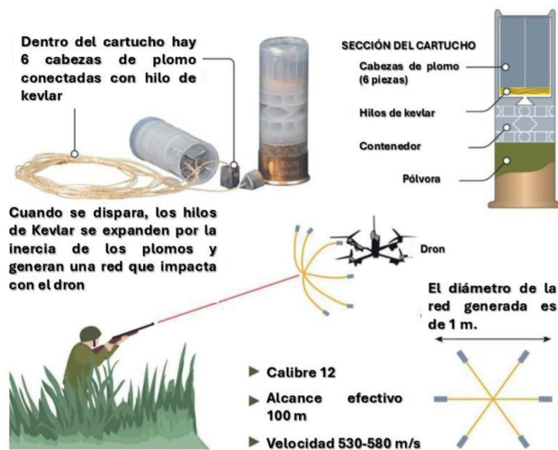
Figura 13. Munición de escopeta anti-dron de origen ruso. Fuente: Esquema propio basado en datos red social X y Telegram.
