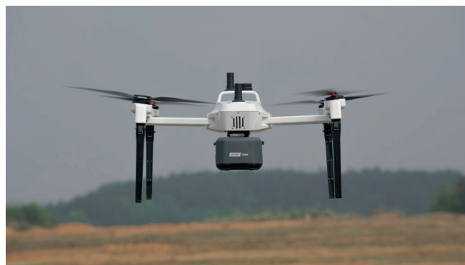
Imagen 45. UAS MINI con recipiente de transporte. Fuente: JOUAV. https://www.jouav.com
