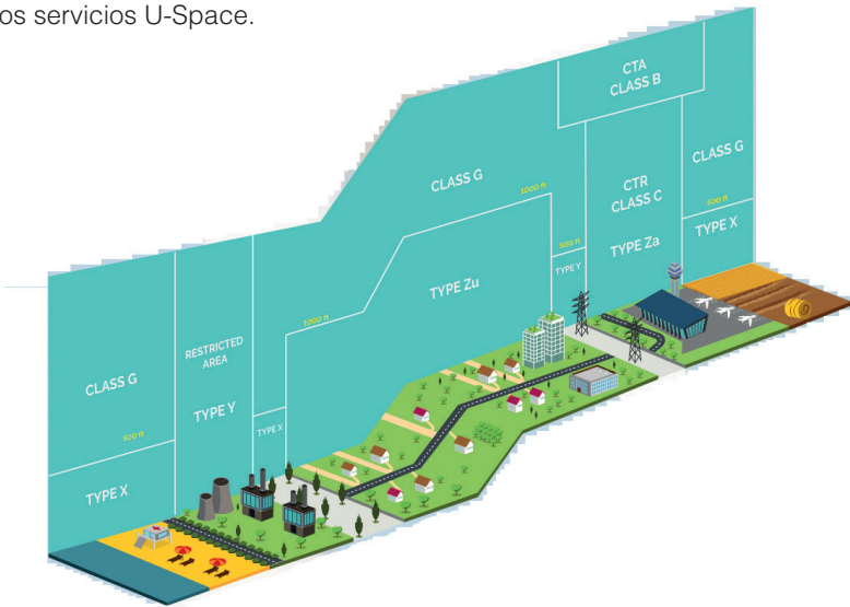
Figura 24. División del volumen de espacio aéreo de baja cota según el proyecto CORUS. Fuente SESAR. U-space Concept of Operations. Permisos solicitados.
