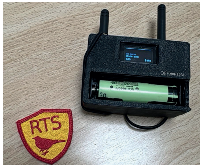
Imagen 58. Dispositivo Tsukorok, Detector personal de UAS, de fabricación ucraniana. Fuente: Empresa Red Team Shield.
