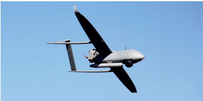
Imagen 32. RADAR SAR IMSAR NSP-3 en UAS Mini. Fuente: web IMSAR
