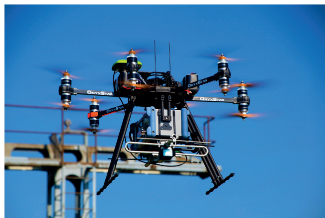
Imagen 35. IMSI Catcher a bordo de un UAS hexacóptero. Fuente: Wikipedia. Autor Cargyrak. Licencia Creative Commons Attribution-Share Alike 4.0
