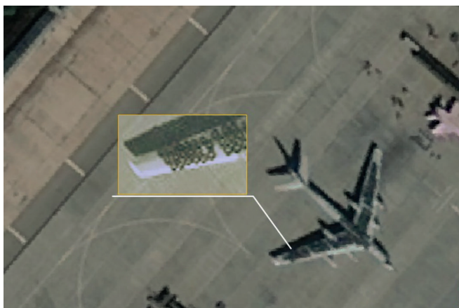
Imagen 34. Bombardero ruso en su aeródromo, cubierto de neumáticos para despistar a los sistemas autónomos de búsqueda de objetivos. Fuente: Telegram. Sin atribución.
