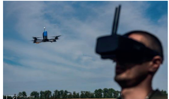
Imagen 13. UAS FPV y operador con las gafas de control, sin carga útil instalada. Fuente: Facebook General Staff of the Armed Forces of Ukraine. Permisos solicitados.
