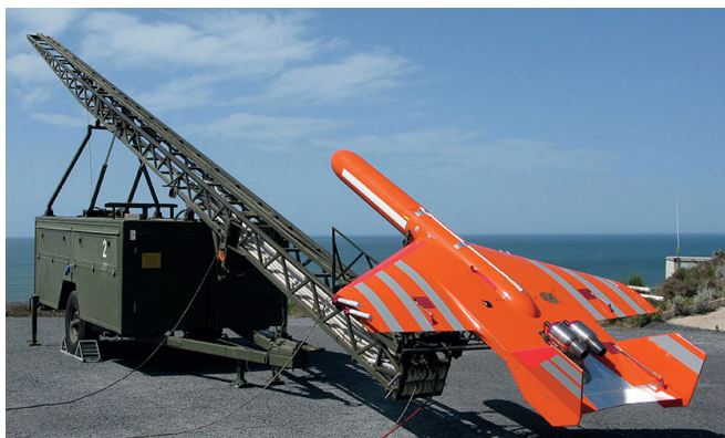
Imagen 30. Blanco aéreo Scrab II, fabricado por la empresa española SCR, en servicio en las FF.AA. Fuente: web SCR - SENER.
