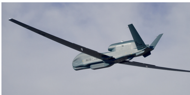
Imagen 33. RQ-4D Phoenix, versión del Global Hawk, del sistema NAGS. Nótese el radar SAR como carga útil. Fuente: NATO / Northrop Grumman.
