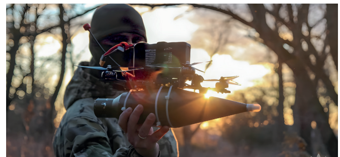
Imagen 14. UAS comercial letalizado FPV, con cabeza de RPG y batería extragrande. Nótese la espoleta protegida por un plástico para permitir su manipulación. Fuente: Facebook General Staff of the Armed Forces of Ukraine. Permisos solicitados.
